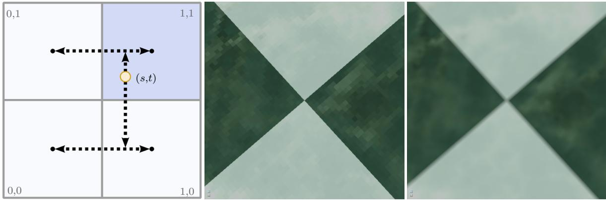
Abbildung 4: Links: Bilineare Filterung - Beim Zugriff auf den Punkt  $(s,t)$  wird bilinear zwischen den angrenzenden Texteln  $(0,0)$ ,  $(0,1)$ ,  $(1,0)$  und  $(1,1)$  interpoliert. Mitte und Rechts: Bilineare Filterung verbessert die Darstellung von Texturen in Bereichen nahe der Kamera.
